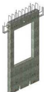
预制围护墙板
